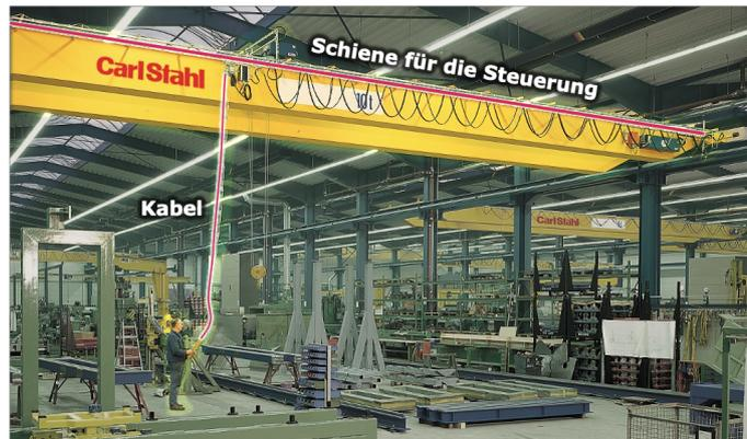
Das Kabel ist entweder direkt an der Laufkatze angebracht oder wird in einer separaten Schiene geführt.
